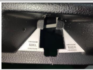
1.7 在图示位置粘贴上我司配有的后踏盖定位纸；沿着定位纸变现将后踏盖割胶；具割胶量以实际装车为准
