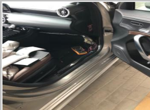
3.7 接正极线: 副驾驶位脚垫里, 找到保险盒;
