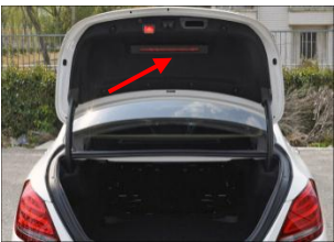
3.2 拆卸塑料扣，原车摇臂上的塑料件拆下
