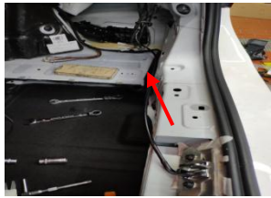
1.9 用扎带把箭头位置的拉线固定好，防止拉线与盖板、钣金摩擦； 注意：内饰板等对插线后再还原
