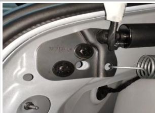
2.5 安装下支架左：用两颗六角头螺栓 M8x25+两颗弹簧垫圈 D8 +两颗平垫圈 D8 拧紧(图示为已经安装完成)；
