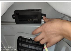
4.1 装 ECU：把 ECU 安放在尾箱右侧此空旷处（圆圈），用 3M 胶贴好防止松动
