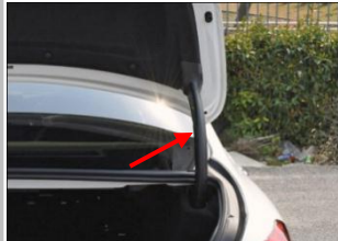
3.3 信号线布置到上门锁，右撑杆电机线沿着后踏板底部把线布置到右侧连接右撑杆
