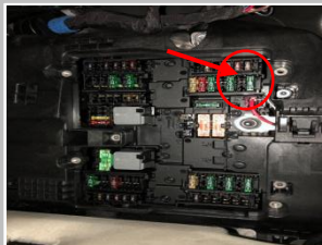
3.8 接正极线: 看到原车保险盒, 正极取电器位置, 按如图方向安装取电器( 正极为上, 取电器出线朝下);
