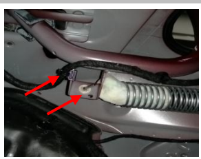
2.3 将原车白色胶圈拆下保存好，后续需要用到；将原车黑色线夹扣拆下。
