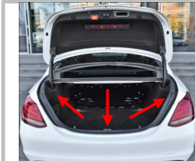
2.1 将尾箱左右两边及底部内饰板拆下；并妥善保管好，后续还原安装；(箭头)
