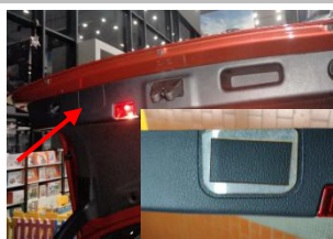
4.3 开关打孔：此处贴上我司配有的开关定位片；沿开关定位片边缘切割上盖板， 具体切割量以实际安装需求为准
