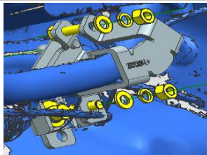
2.8 按图示位置正确安装上支架组件二（左-A200）：
