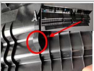
1.6 将后踏盖右侧凸筋割胶;具体割胶量以实际装车为准
