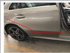
3.11 正极线和解码器控制线 : 穿过后排脚踏内饰, 到后备箱
