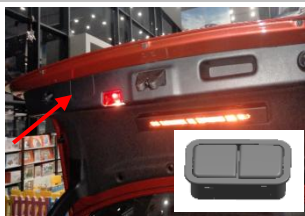
4.4 安装开关按钮：上盖板割胶后，将开关按钮安装到割胶位置
