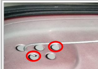
2.4 将两颗六角平头铆螺母 M8x21 按图示标记位置装在原车上
