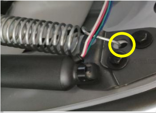
2.11：安装拉簧：反向安装（短拉钩的一头装在下支架），上支架安装点如图 2.0 所示，右边用同样方法安装
