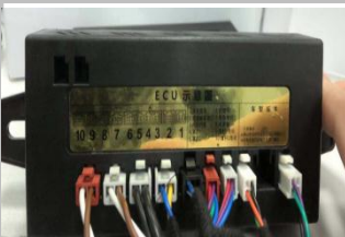
4.2 连接 ECU，待所有线束插好，最后插电源线插头；（插头如前面 ECU 插头示意大图）
